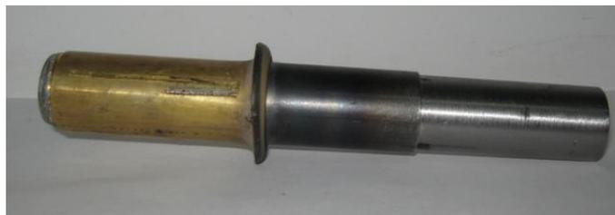
Figura 3. Unión entre latón y acero 1045
